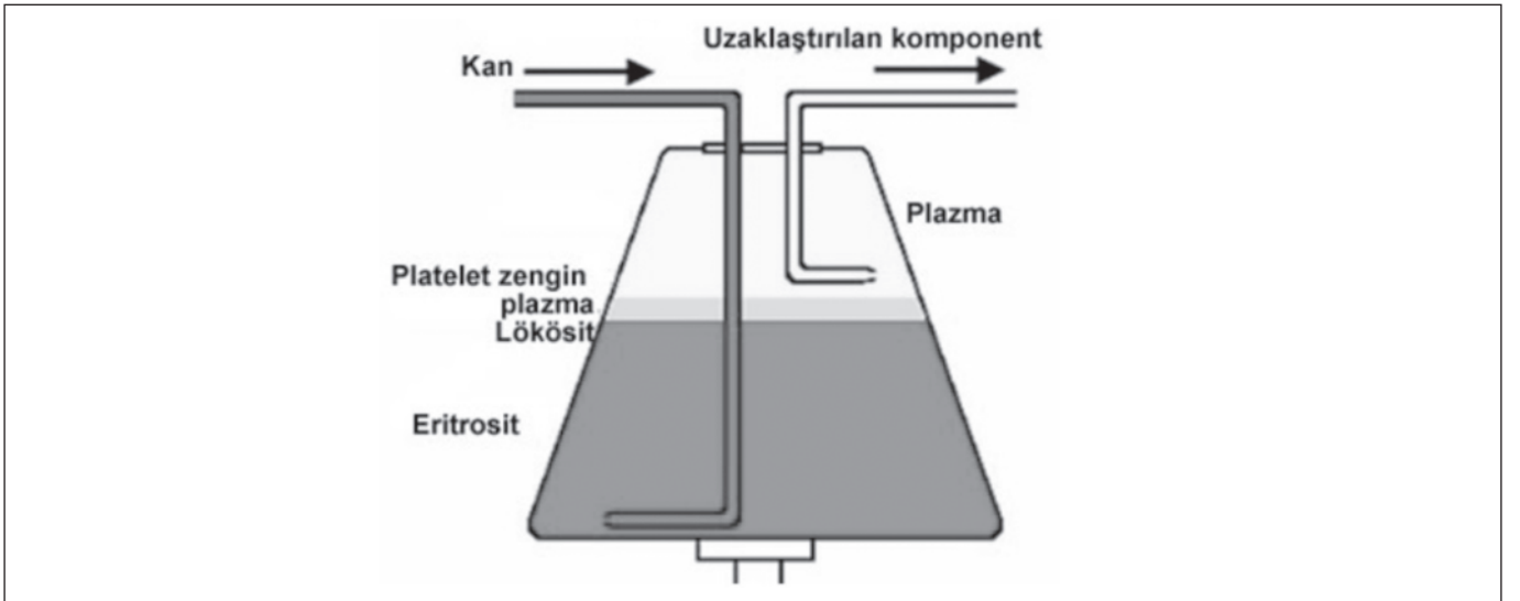
Şekil-3: Aferez cihazı santrifüjündeki tabakalanma
